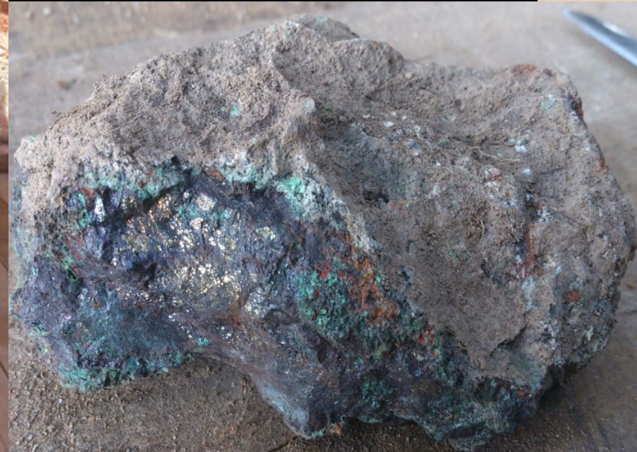
Área Piedra Imán: muestra con magnetita e inclusiones de calcopirita-malaquita
